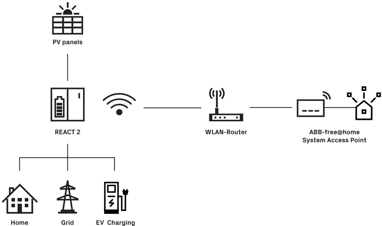
L'integrazione di FIMER REACT 2 nel sistema ABB-free@home® è possibile grazie all'integrazione del protocollo di ABB-free@home® in FIMER REACT 2. I dati di FIMER REACT 2 vengono trasmessi tramite protocollo IP all'access point del sistema ABB-free@home® che a sua volta controlla gli altri dispositivi collegati.
