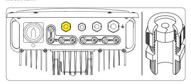
Nach Einführen des Kabels durch die Kabelverschraubung, fahren Sie mit der Installation des Ringkernwandler (mitgeliefert) fort:
