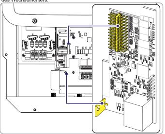
Danach kann das Ethernet-Kabel angeschlossen werden.
