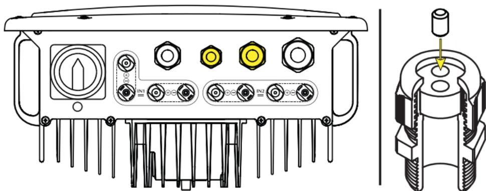
**NOTE** – Su ogni pressacavo è possibile installare le guarnizioni a due fori (fornite a corredo dell'inverter) per l'installazione di cavi di piccolo diametro
