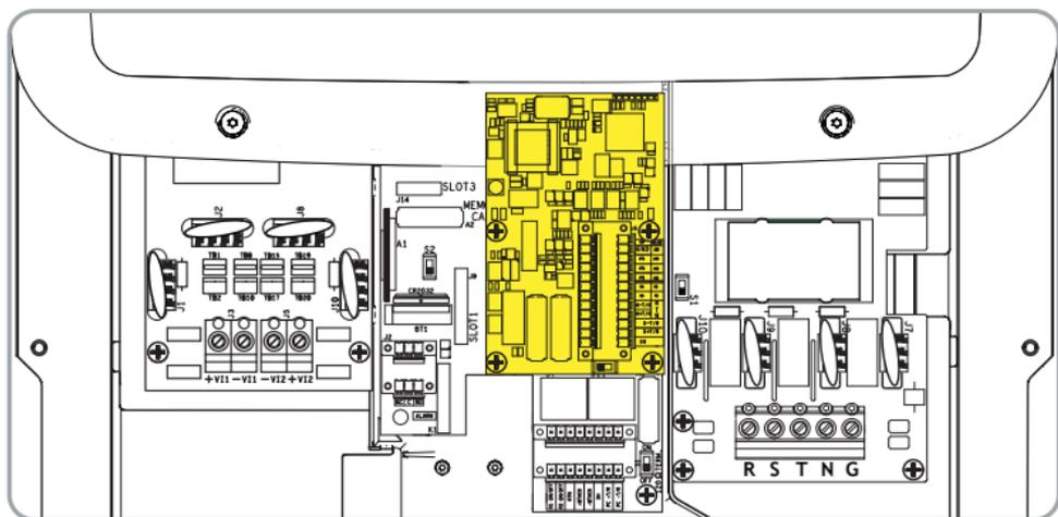
Al termine della procedura di installazione è possibile effettuare il collegamento dei segnali di comunicazione e controllo
