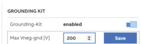
**ATENCIÓN** – Este parámetro identifica la tensión umbral entre el polo negativo y tierra, que dispara la desconexión del inversor por fallo de tierra (E037).
