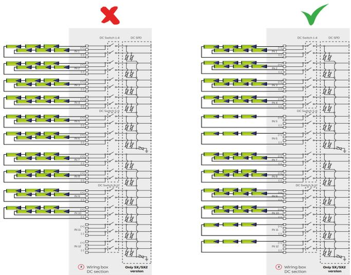
⚠ **ATENCIÓN** – Cuando se configura la entrada CC, y durante la instalación, se requiere seguir una norma básica para evitar una posible degradación de potencia de la salida: Todos los MPPT se rellenarán conectando al menos una cadena. Si se considera conectar 20 cadenas, conecte una cadena por MPPT y, a continuación, conecte las cadenas restantes en los MPPT seleccionados donde desee utilizar 2 cadenas.
