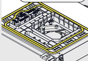
Tout dommage sur les joints pourrait causer de graves défauts à l'appareil et entraînerait l'annulation de la garantie.
