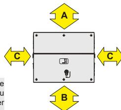
**ATTENTION** – N'installez aucun objet (câbles CA ou CC, par exemple) susceptible d'être endommagé par la surchauffe du flux d'air chaud sortant des parties supérieure et latérale du ventilateur ( $\Delta T = +15^\circ \text{C}$  par rapport à la température ambiante). Le cas échéant, veuillez envisager l'installation d'un déflecteur d'air approprié sur ce type d'installation. Respectez toujours les distances minimales requises.
