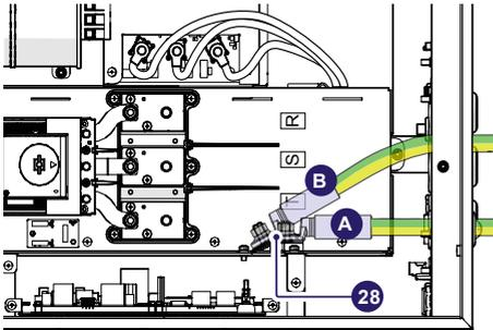
**⚠ ATTENTION** – En fonction de la version du panneau CA installée sur l'onduleur, il est nécessaire d'utiliser un autre point de connexion à la terre de protection afin d'éviter les contraintes mécaniques dues à la courbure du câble. Dans le cas d'un panneau CA monoconducteur, utilisez le point de connexion horizontal (A). Sinon, dans le cas d'un panneau CA multiconducteur, utilisez le point de connexion incliné (B).
