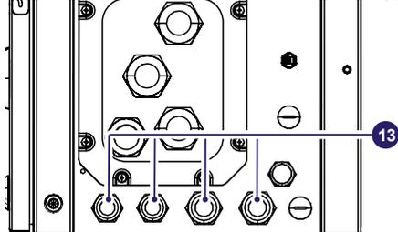
**NOTE** – Sinon, le joint standard des serre-câbles PG21 peut également être remplacé par le joint d'étanchéité à deux trous (fourni dans le kit d'installation de la boîte de raccordement électrique), qui accepte deux câbles distincts de 6 mm de diamètre. Si aucun trou n'est utilisé, un bouchon (cylindre en plastique fourni) doit être installé pour assurer l'étanchéité de l'onduleur.
