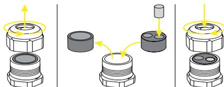
**ATTENTION** – Vérifiez que tous les serre-câbles non utilisés (13) sont bien hermétiques au moyen d'un capuchon en plastique de degré IP65 (préinstallé sur les serre-câbles).
