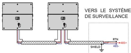
La ligne RS485 prend en charge le protocole Modbus compatible avec Modbus/RTU SUNSPEC.
