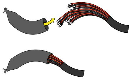
• Faites passer les câbles d'interface CC (33) dans la boîte de raccordement électrique en utilisant l'ouverture prévue à cet effet pour les câbles CC (30), comme indiqué sur l'image.
