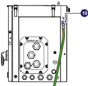
**⚠ ATTENTION** – La cosse de câble doit être installée avec un couple de serrage de 15,2 Nm.
