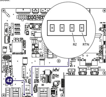
Puisqu'il s'agit d'une entrée numérique, il n'existe aucune exigence à respecter concernant la section des câbles (elle doit simplement être conforme aux exigences de dimensionnement pour faire passer les câbles via les serre-câbles et le connecteur des bornes).
