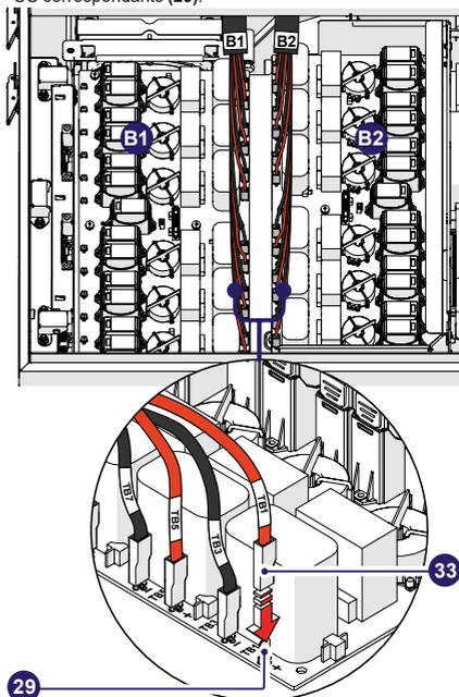
⚠ **AVERTISSEMENT** – L'inversion de polarité peut provoquer de graves dommages. Vérifiez la polarité avant de raccorder chaque câble !
