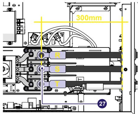
**⚠ ATTENTION** – Si la séquence de phase est incorrecte, l'onduleur ne se connecte pas au réseau et génère un état d'erreur.
