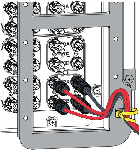
Suivez l'ordre d'installation indiqué sur la figure, afin de raccorder les câbles proprement. La figure indique également les bons trous sur le chemin de câbles qui doivent être utilisés pour bloquer les câbles de chaque MPPT.
