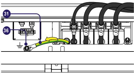
**⚠ ATTENTION** – La cosse de câble doit être installée avec un couple de serrage de 3 Nm.
