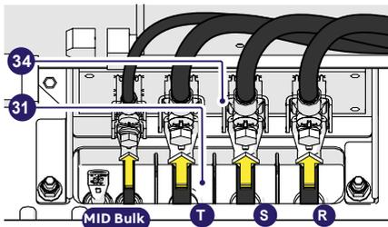
**⚠ ATTENTION** – Si la séquence de phase est incorrecte, l'onduleur ne se connecte pas au réseau et génère un état d'erreur.
