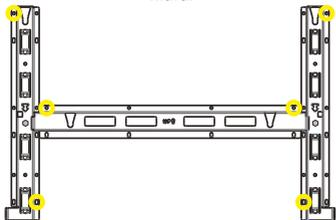
**Montage du cadre (2 supports) points de fixation minimum**
