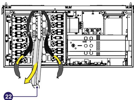
• Raccordez tous les câbles d'interface CC (33) aux connecteurs Faston d'interface CC correspondants (29) situés dans le parafoudre CC (21). Les deux groupes de câbles sont identifiés par une étiquette « B1 » et « B2 » correspondant à celle du numéro de carte DSP (« B1 » et « B2 »). Sur les cartes DSP
