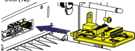
• Serrare la vite fornita per fissare in posizione il PVS-20/30/33-CCB (coppia di serraggio 4 Nm).
