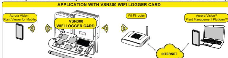
**ATTENTION** – Um den korrekten Betrieb der Karte zu gewährleisten, sollten zusätzlich zur VSN300 WIFI LOGGER CARD keine anderen Überwachungsgeräte installiert werden.
