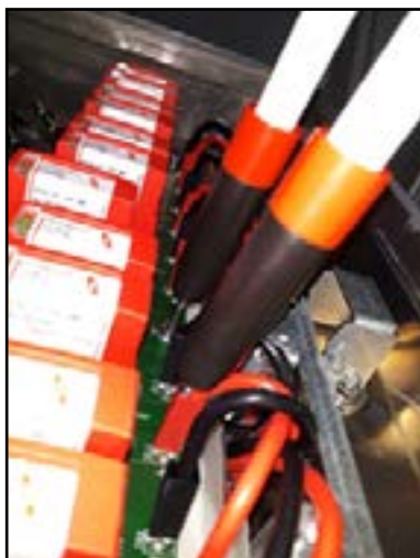
Exemple : Test entre CH3(+) et PE
