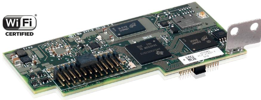
La VSN300 Wifi Logger Card est une carte d'extension dernier cri pour les onduleurs de chaînes UNO et TRIO d'ABB, fournissant aux utilisateurs résidentiels et commerciaux une solution de pointe rentable pour la supervision et le contrôle de leur système photovoltaïque.
